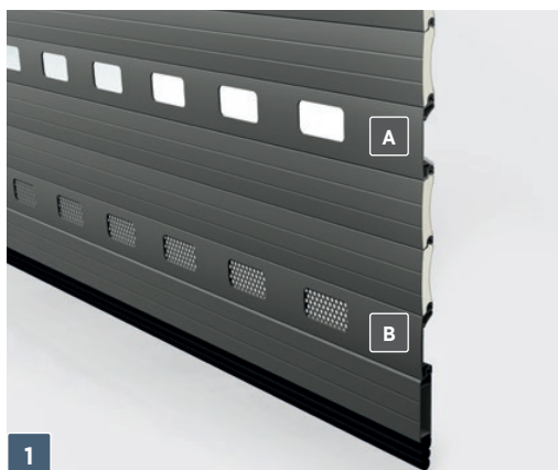
1 Kurtyna bramy – wykonana z profili aluminiowych o wysokości 100 [mm] i grubości 25 [mm] wypełnionych bezfreonową pianką poliuretanową. (A) – jednościankowy aluminiowy profil przeszklony, (B) – jednościankowy aluminiowy profil wentylowany.
