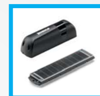
RF.SUN 510zł 9409015 Nadajnik 868 MHz do krawędzi bezpieczeństwa. Zawiera: 1 akumulator ładowany panelem fotowoltaicznym. Wejście na rezystancją 8K2 lub mechaniczną krawędź bezpieczeństwa (opis str. 172).
