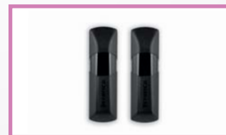
PUPILLA 9409001 180zł Para fotokomórek synchronizacyjnych 24Vdc do montażu natynkowego, kąt regulacji 180°. (110X36X31mm). Istnieje możliwość synchronizacji do 4 par fotokomórek. Dioda LED ułatwia i przyspiesza centrowanie promienia.
