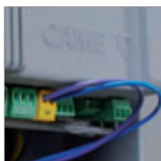
Wejście BUS obsługujące technologię CAME CXN BUS.
