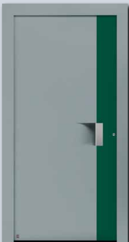
Wzór 301 ThermoCarbon w preferowanym kolorze szarym matowym, RAL 7040, aplikacja aluminiowa w preferowanym kolorze zielonym, matowym, RAL 6005, listwa uchwytna z eloksalowanego aluminium, E6 / EV1, zagłębienie w kolorze drzwi
